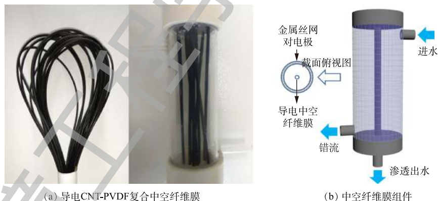
图 2 导电 CNT-PVDF 复合中空纤维膜和相应的中空纤维膜组件图片
